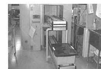
図8 新中検（検体専用ボックスレベーター）
